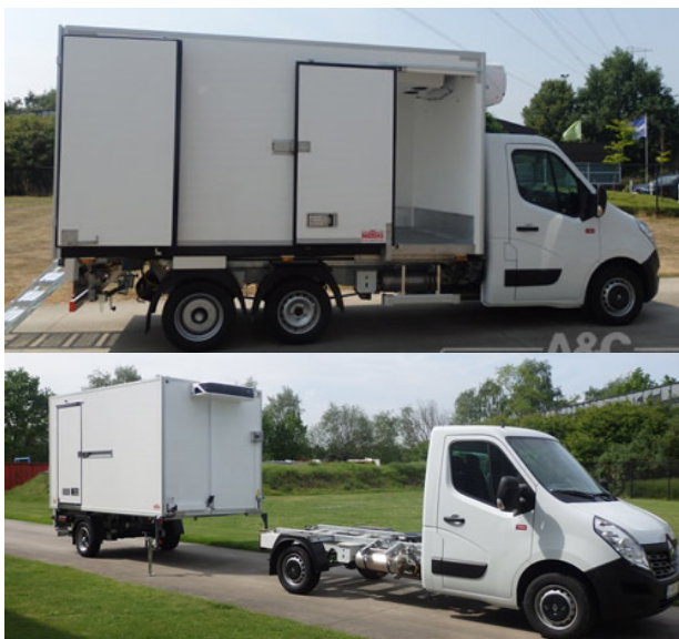
Figur 3. BE-lastbil av typen Clickloader, vilket är en sammankoppling av ett BE-dragfordon och ett fastsläp som möjliggör en högre lastkapacitet 23 .
