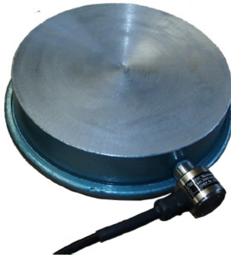
Figur 14. Lastcell av typ Glötzl KKLN 2000 AU6. Från [12].
