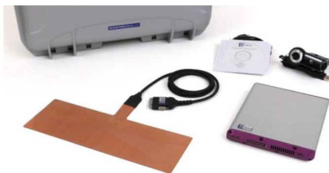
Figur 15. Taktill tryckgivare med kringutrustning. Från [13].
