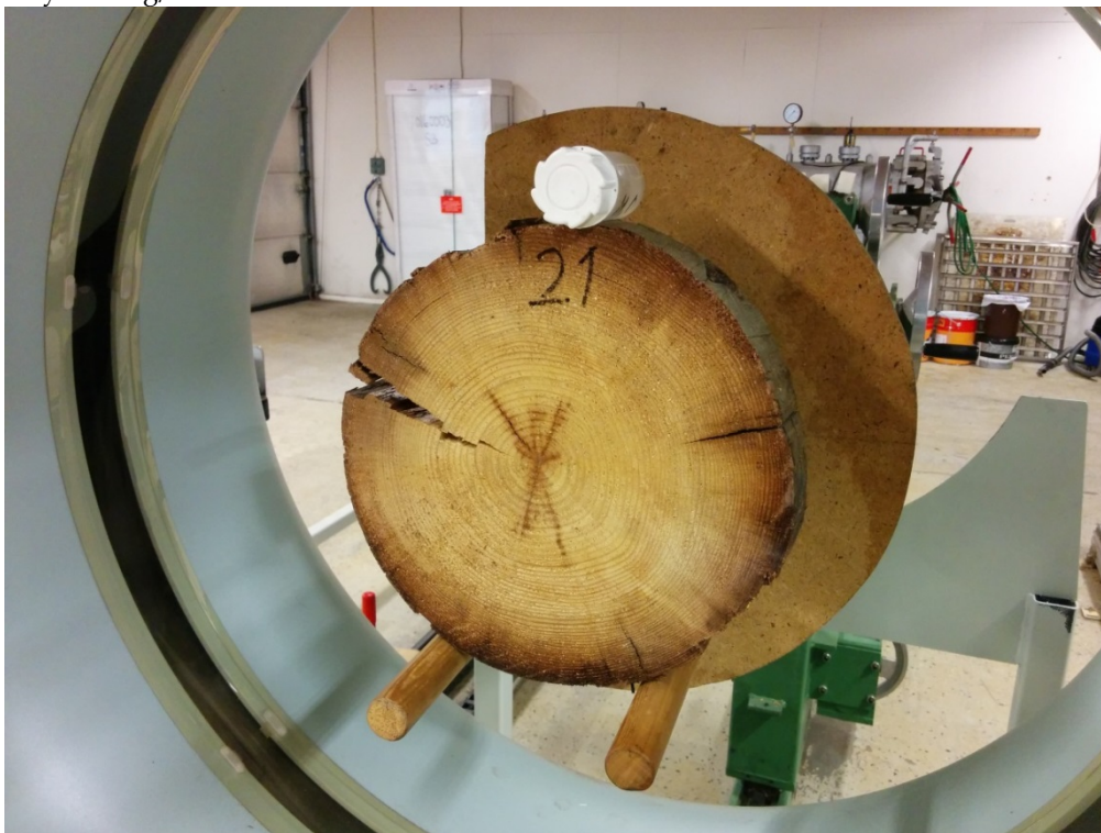
Bild 3.1 Torkat tvårsnitt monterat i tomografen.
