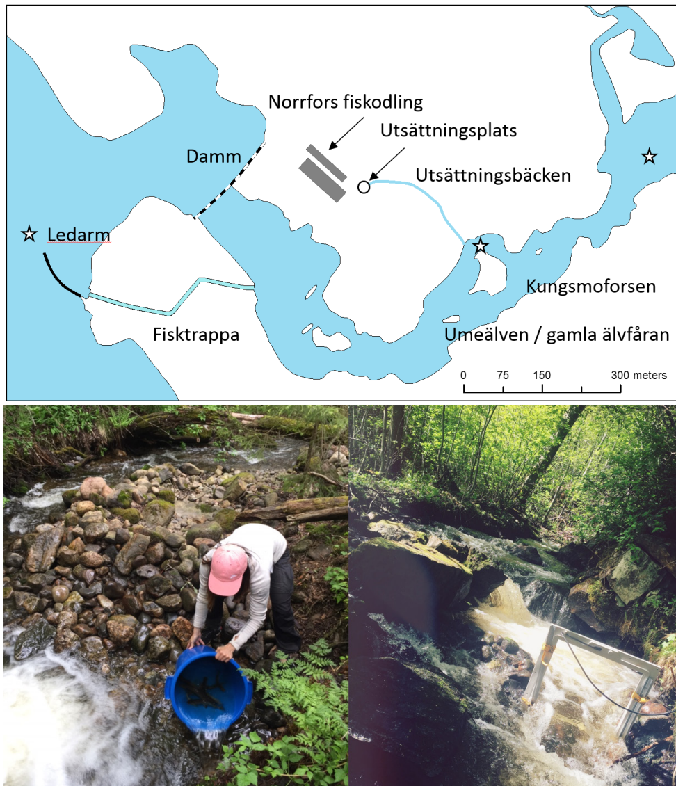
Figur 3. Den övre bilden visar en schematisk karta över Stornorrfors damm, fisktrappa, fiskodling och utsättningsbäcken. Stjärnor visar logger placeringar i området. Nedre bilden till vänster visar utsättningsplatsen där vattnet från odlingen kommer ut via ett rör. Nedre bilden till höger visar bäcken med PIT-tag antenn för registrering av nedströmsvandrande fiskar. (foto Samuel Shry)
