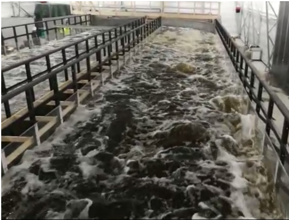
Figur 6 Kungsrännan i drift med 1,5 m vattendjup.
