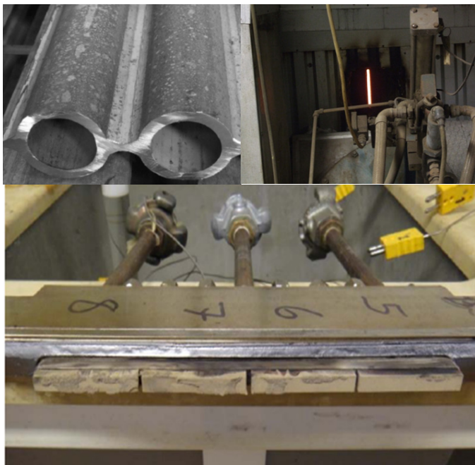
Fig. 1 Övre vänster. Del av en eldstadsvägg före installation i en panna. Väggen består av tuber svetsade tillsammans med en fena i mellan.
