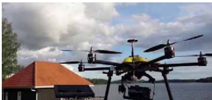
Skanning med drönare – inmätning som läggs in i 3d-modell
