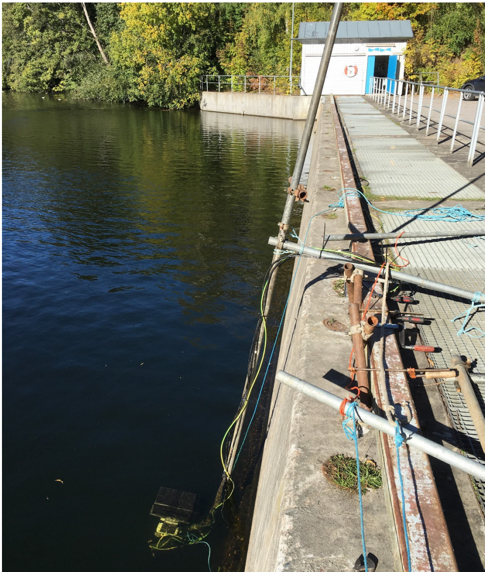
Figur 4. Montering av ARIS och DIDSON LR vid Holmens intag, DIDSON är monterad närmast vattenytan och riktad vinkelrätt ut från kajen; ARIS kan skymtas under, riktad ca 40° åt vänster. Längst bort i bild syns servicehuset som använts som kontrollcentral.
