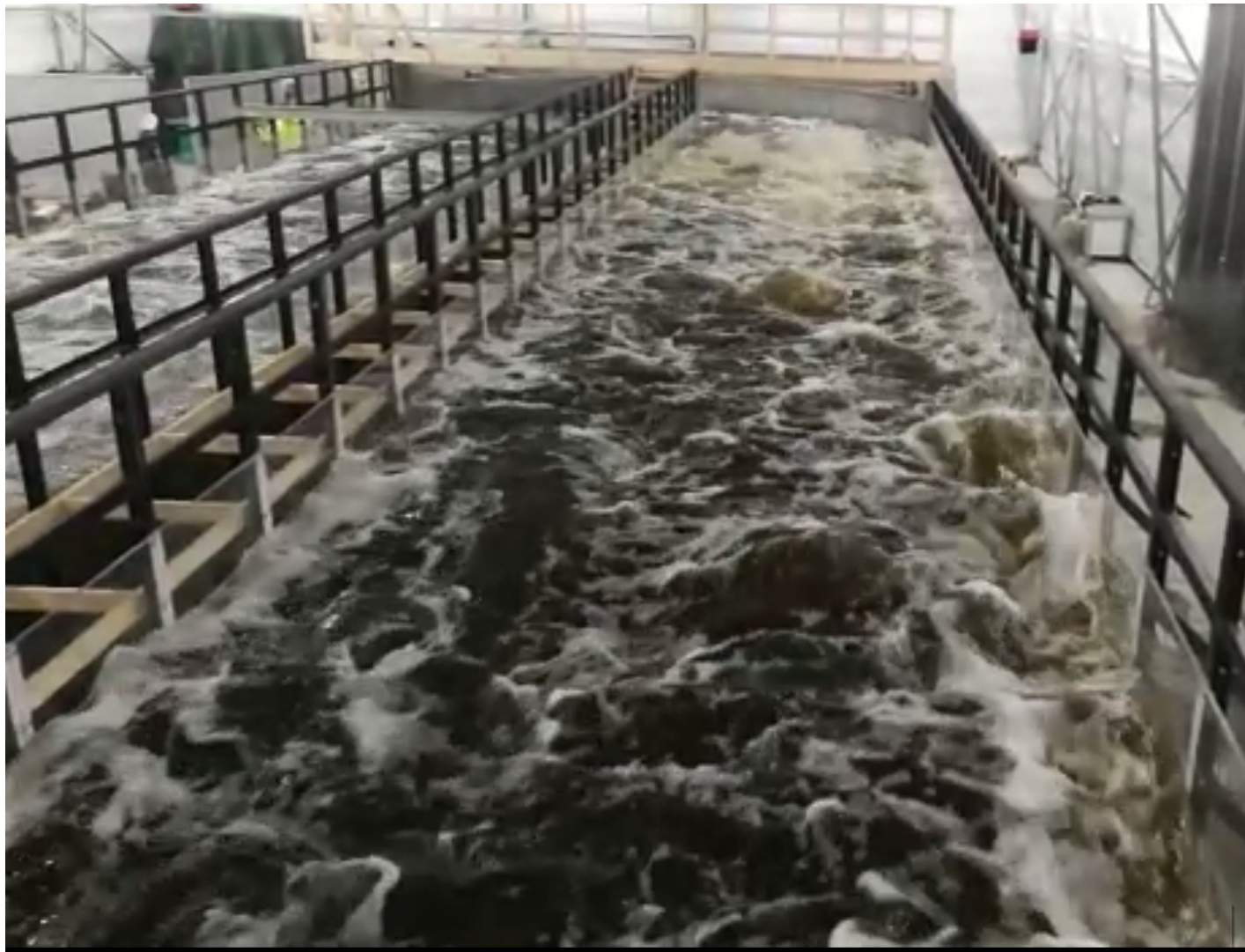
Figur 2. Kungsrännan i drift med 1,5 m vattendjup.
