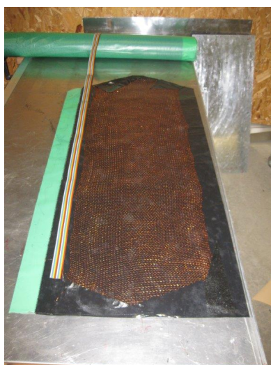
Figur: Kopparväv överst och exposi-prepreg, underst.
