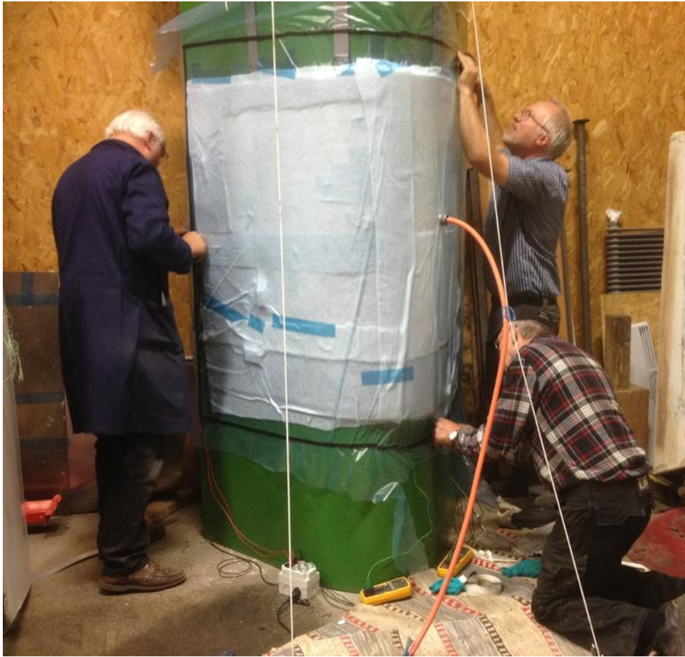
Figur: Härdning av uppvärmningsmodul på bladprofil
