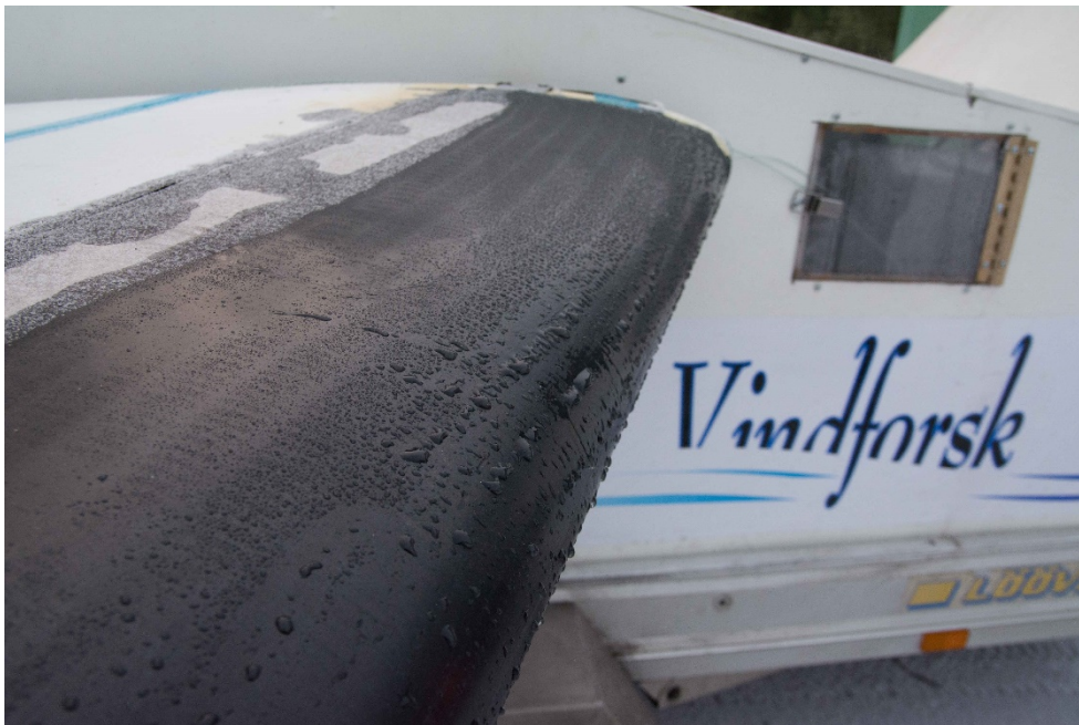
Figur: Samma blad med avisningen påslagen
