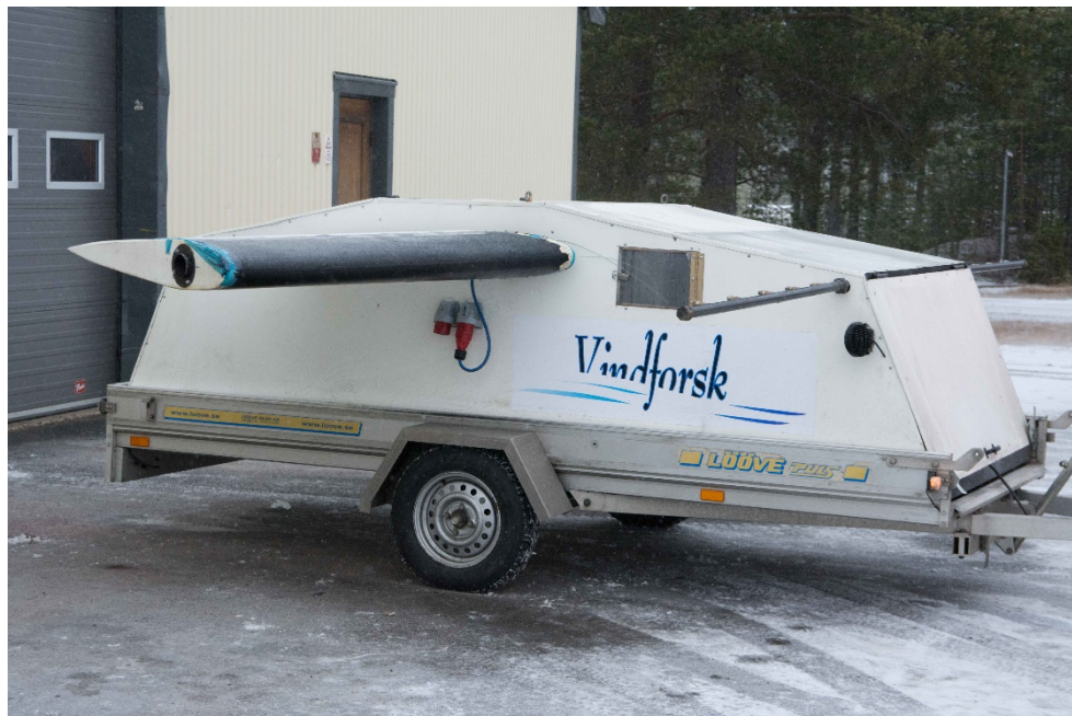
Figur: Testekipage med bladprofil och anordning för att spraya vatten från röret till höger
