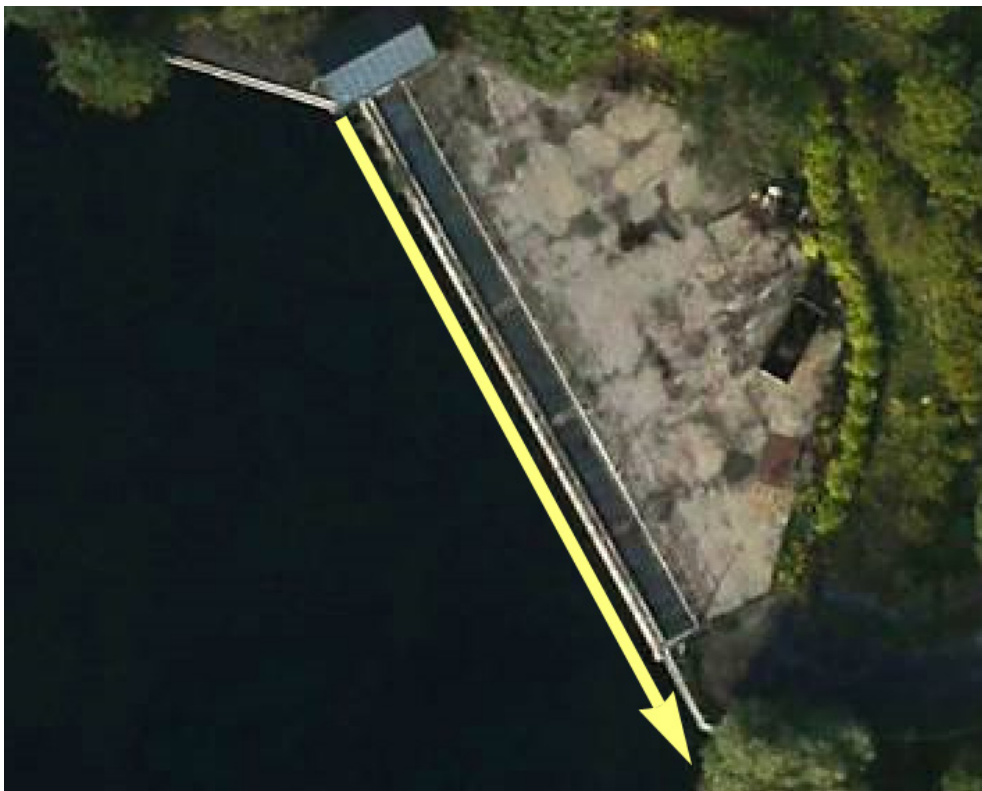
Figur 5. Närmast intaget till Holmens kraftverk gjordes ADCP-mätningar längs tätare transekter parallellt med intagsgallret. Pilen visar riktningen för transekterna, med start vid servicebyggnaden i riktning mot sydost. Resultaten från mätningarna presenteras i riktning
