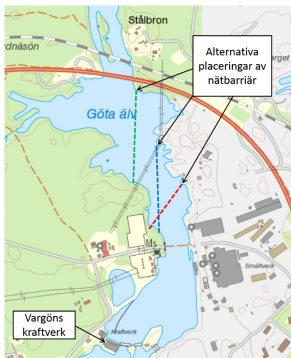
Figur 23. Rekommenderade placeringar av en nätbarriär uppströms Vargöns kraftverk i Göta älv (opublicerat, Pacific Netting, 2017).
