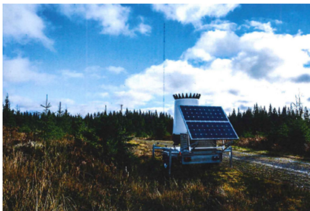
AQSIO Wind Finder SODAR placerad vid Hornamossen masten (nedre figuren). Foto: Johan Arnqvist (Uppsala universitet)/Kalle Wikmyr (AQSystem).
