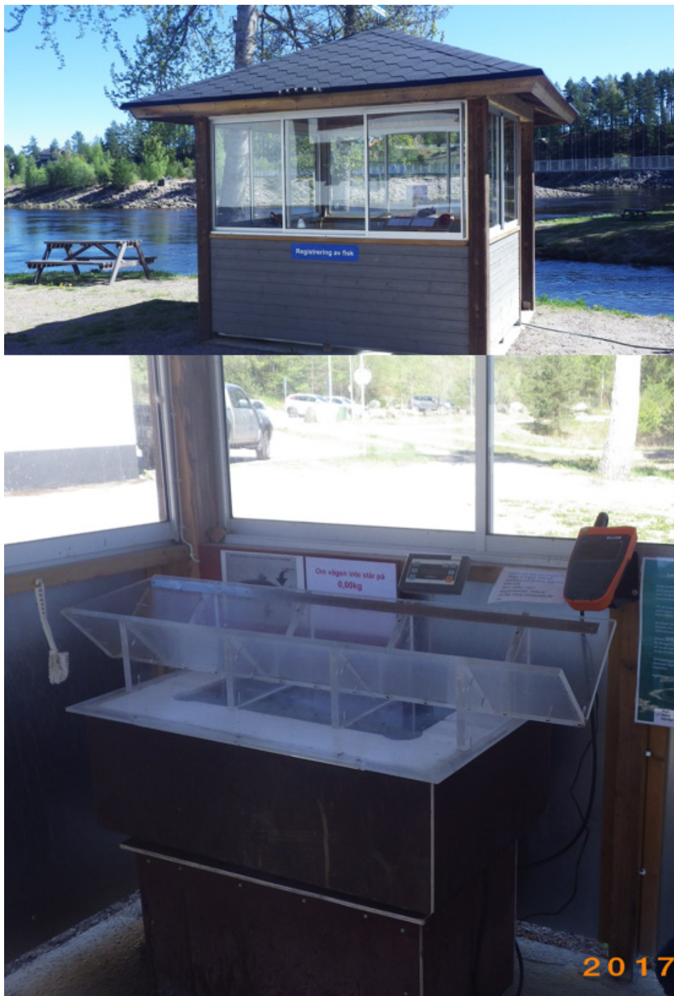
Bild 3. Den övre bilden visar mätstationen i Dalälven där sportfiskare kan väga, mäta och rapportera sin fångst. Nedre bilden visar den kombinerade mätbrädan och vågen med inbyggd PIT-tag antenn (Foto: Jörgen Rask).
