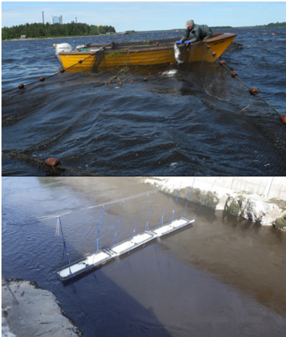
Bild 4. Övre bilden visar vittjning av laxfälla i Umeälvens mynningsområde där fiskaren skannar all lax efter PIT-tags (Foto: Anders Alanärä). Nedre bilden visar de flytande PIT-tag antennerna som monterades i utloppskanalen från en av turbinerna i Älvkarleby. Den totala bredden på de tre antennerna var ca 9 m (Foto: Jörgen Rask).
