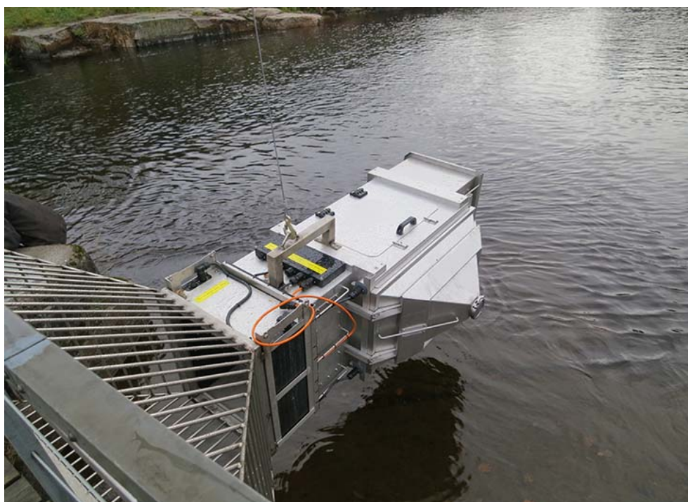
Figur 18. Vaki RW fiskräknare med från vänster till höger i bild: galler, skannerenhet, fototunnel. Mitt på fototunneln syns det runda kamerahuset.
