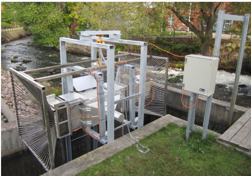
Figur 6. Vaki RW fiskräknare med från vänster till höger i bild: skannerenhet, fototunnel och kontrollenhet. Mitt på fototunneln syns det runda kamerahuset.
