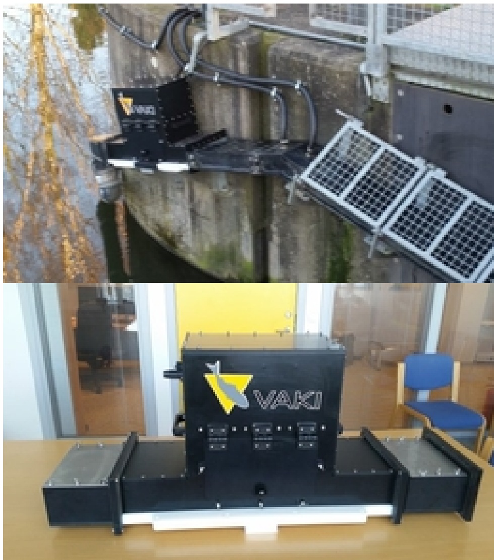
Figur 30. Vaki ElverWatcher är avsedd för att räkna uppvandrande ålyngel.
