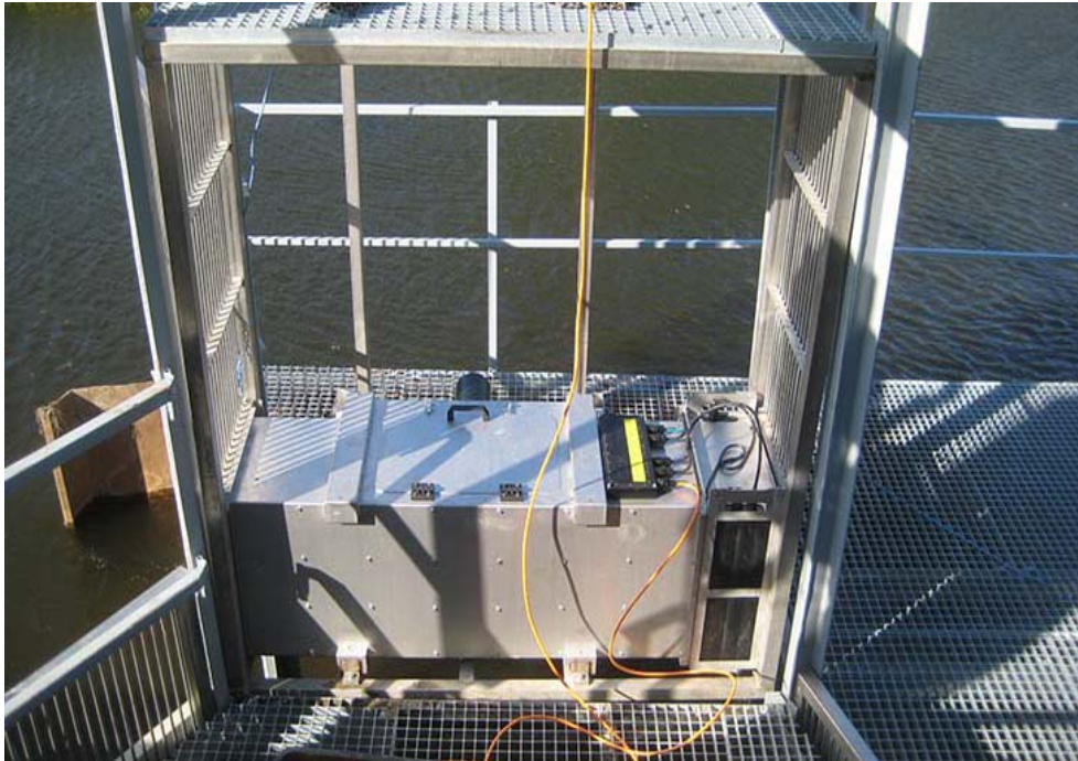
Figur 9. Vaki RW fiskräknare med från vänster till höger i bild: fototunnel och skannerenhet.
