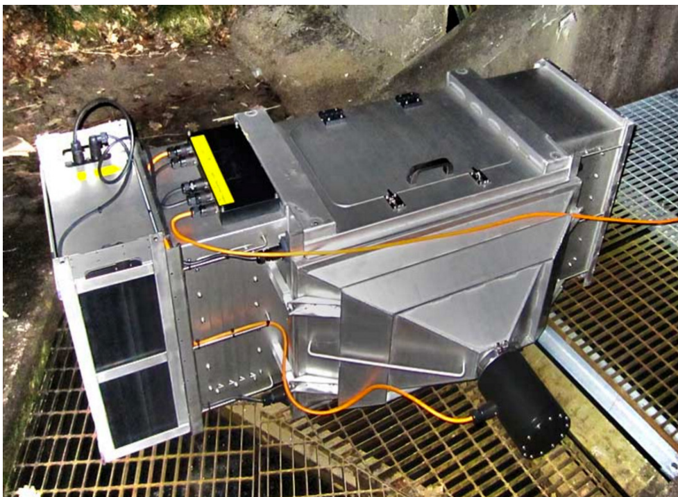
Figur 12. Vaki RW fiskräknare med från vänster till höger i bild: skannerenhet och fototunnel.
