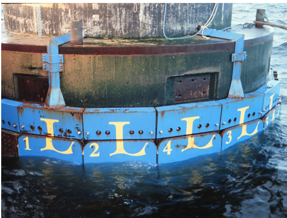
Figur 2-1. Paneler för fullskalemätning av islast mot fyren vid Norströmsgrund (Foto: Lennart Fransson, LTU).
