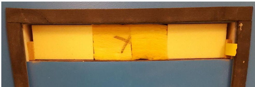
Figur 7. Körning med GHFM med cellplast på sidorna och skarvad mineralull i mitten.
