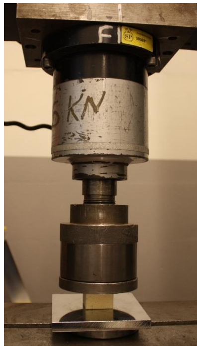
Figur 10. Utrustning för mätning av radiell tryckhållfasthet. Tryck appliceras vertikalt på rätblocket.
