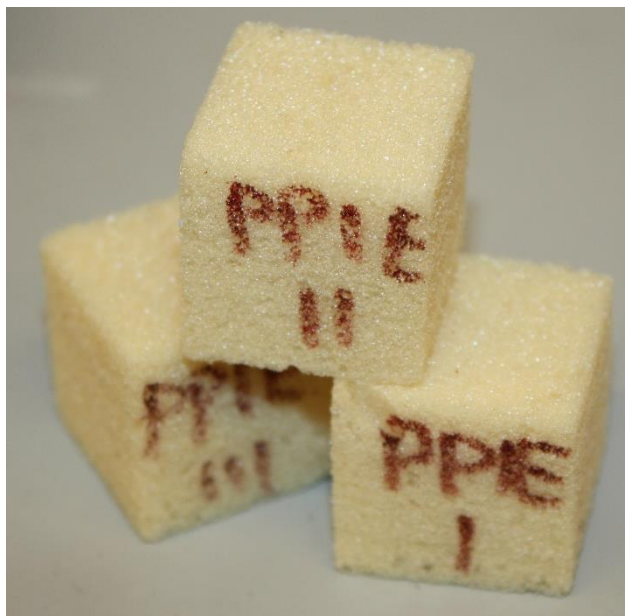
Figur 12. Kuber för bestämning av slutna celler. Tjockleken är 25 mm och de extraheras från mitten av rörets skum.
