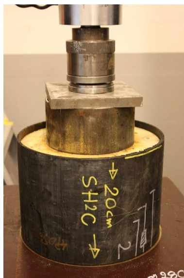
Figur 8. Bild från provtillfälle för bestämning av axiell skjuvhållfasthet. I det här fallet har skummet släppt i vidhäftningen mot mantelröret.
