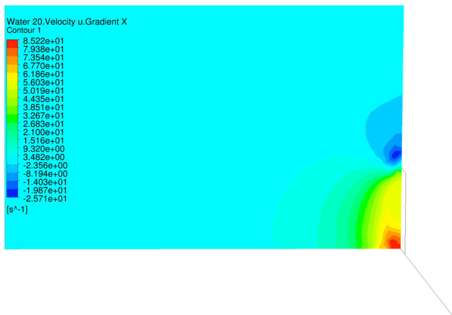
Figur 6. Hastighetsgradienten i strömningsriktningen i ett plan i mitten av den ena spilluckan, 0.2x0.2 m
