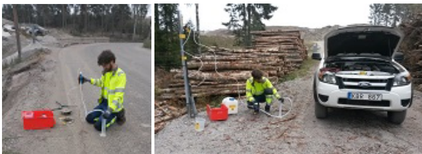
Figur 11 Provtagning av vatten från lysiemter där pumpen drevs av bilbatteri
