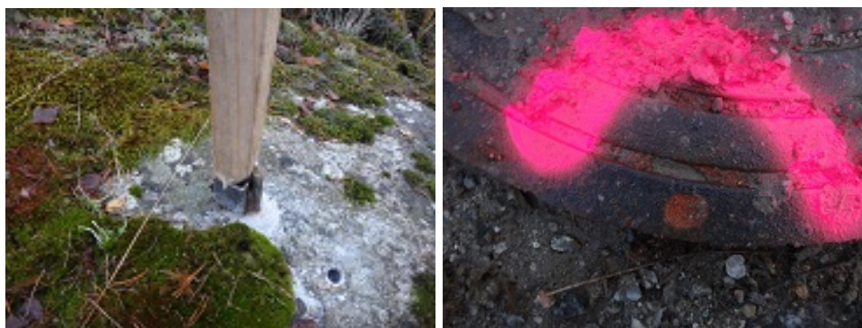
Figur 13 Foton på fixpunkt för sättningsmätningar samt markerad punkt på brunn
