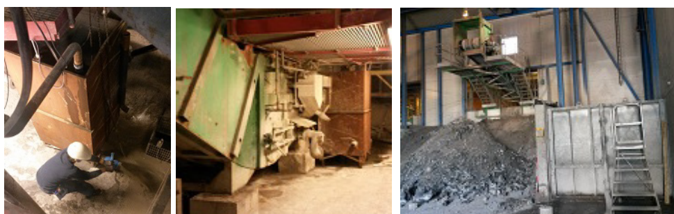
Figur 3 Tvättutrustning vid våtutmataren. Vänster recirkulationslådan uppifrån. Mitten våtutmataren från sidan med recirkulationslådan (tvätttank) längst bort. Höger slaggutmatning i slagghuset, och bassäng för sedimentering innan vatten förs vidare till rökgaskondensatrening.
