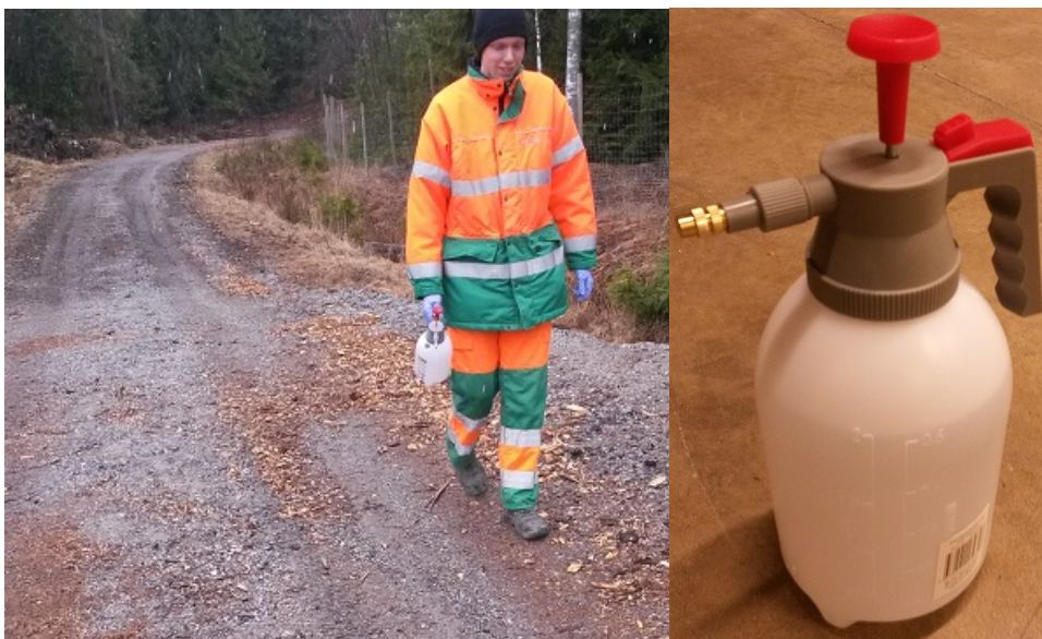
Figur 14 Manuell saltning av angränsande referensyta och tryckspruta som användes.
