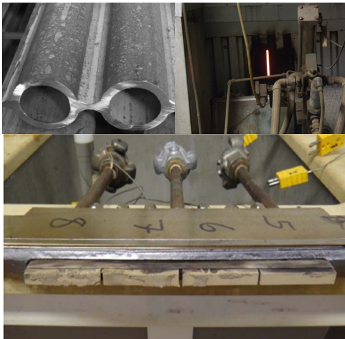
Figur. 1 Övre vänster. Del av en eldstadsvägg före installation i en panna. Väggen består av tuber svetsade tillsammans med en fena i mellan.
