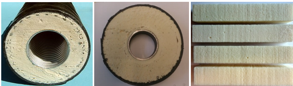
Figur 5 - Fjärrvärmerör (vänster), skivor tagna ur rör (mitten), provkroppar tagna ur isoleringen (höger)
