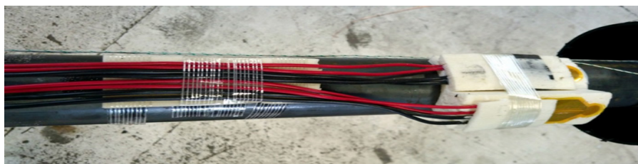
Figur 6 - Placering av TPS sensorer på stålrör
