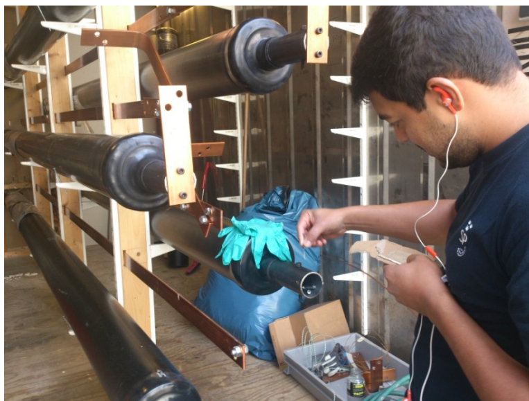
Figur 8 - Montering av rör för accelererad åldring i luft
