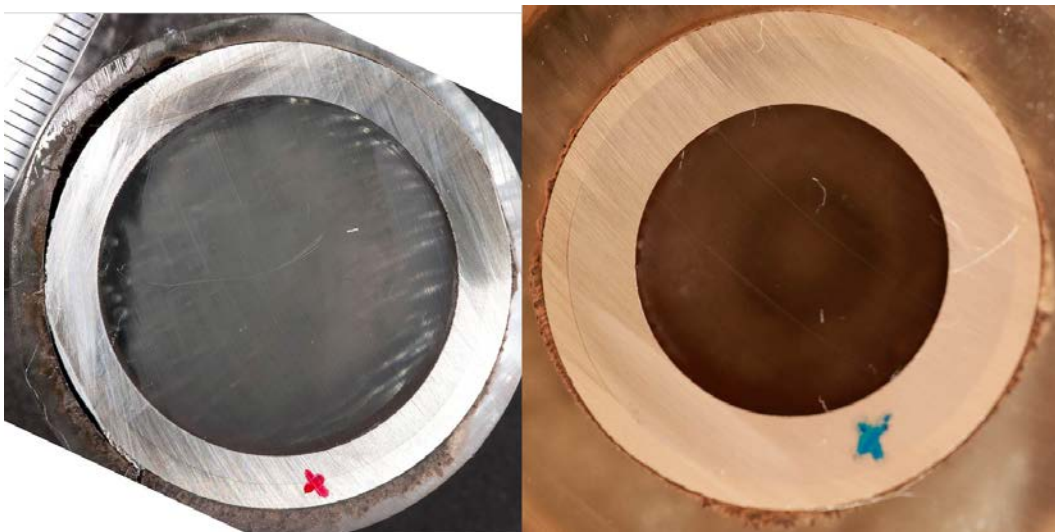
Figur 36. Tvärsnitt av Sanicro28 exponerad vid 420°C i 5600 timmar. Till vänster: sondprov. Till höger: Tubprov
