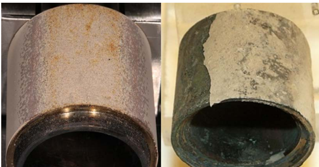
Figur 32. Optiska bilder av vindsidan av Sanicro28 exponerade med korrosionssond vid 500 °C. Till vänster: Långsam start (start från kall panna, ~72 timmar med oljeeldning innan 24 timmar med avfallsförbränning) Till höger: Snabb start (24 timmar med avfallsförbränning, kall sond installerades direkt in i en varm panna).
