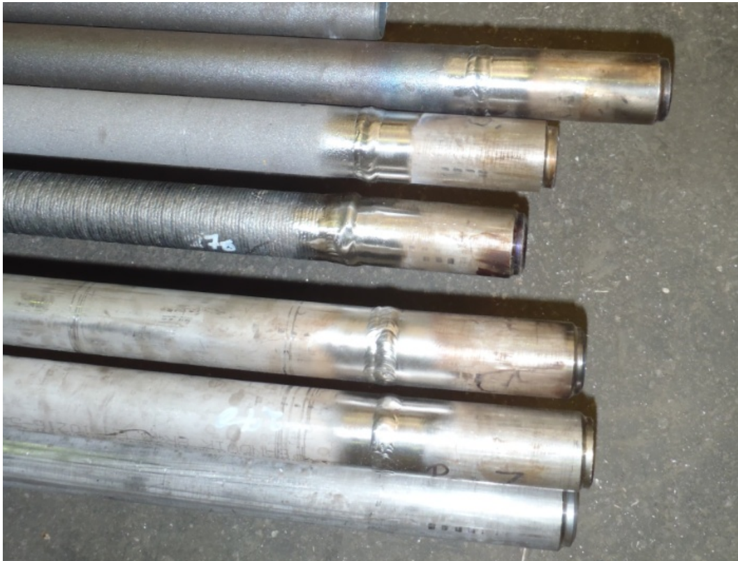
Figur 9. Testtuber med svetsändar. Nerifrån och upp i bilden: Sanicro28/St48-8, TP347H, TP310HCbN, Inconel625/St48-8, FeCrAl/13CrMo4-5, and 13CrMo4-5.
