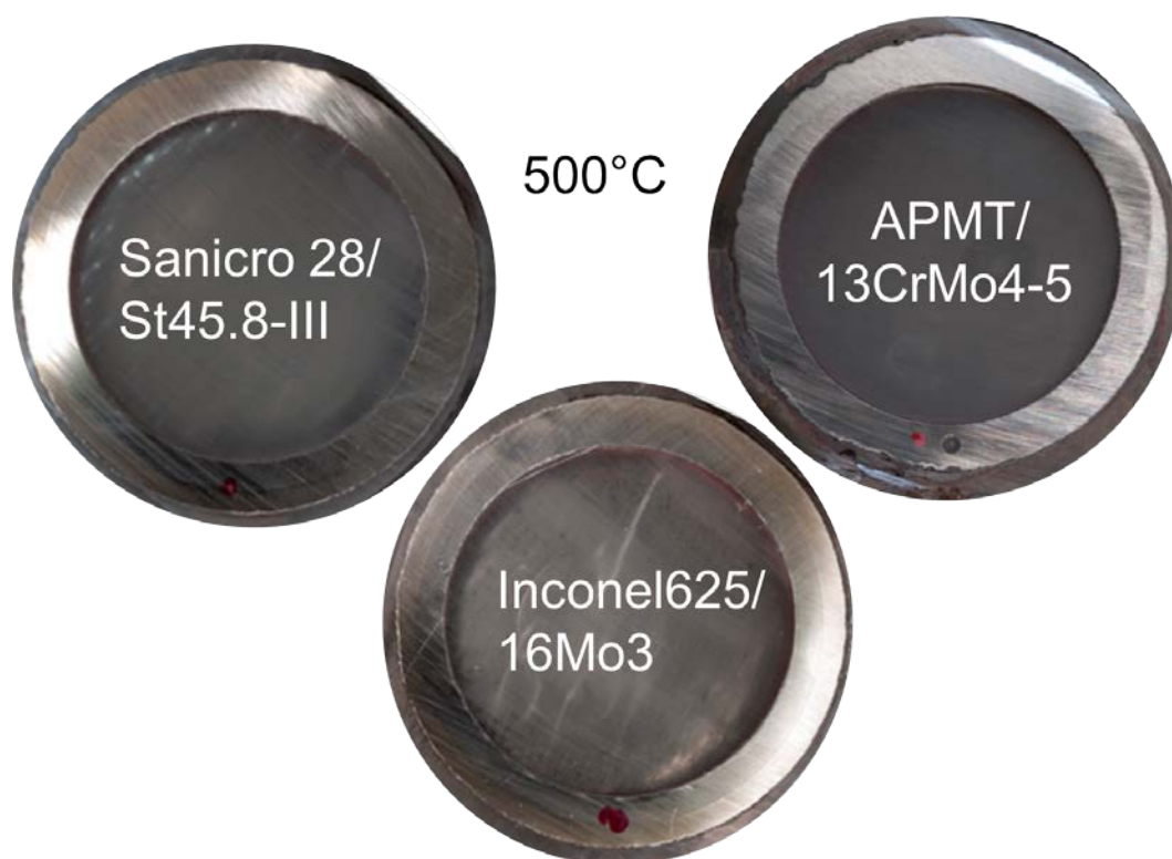
Figur 21. Optiska bilder av tvärsnittet av provringarna exponerade vid 500 °C i 5600 timmar. Den röda pricken markerar vindsida.
