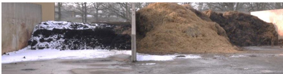
Figur 3. Lagring av vattenverksslam (till vänster) och gödsel till höger vid en biogasanläggning. (Foto Annika Nyberg)
