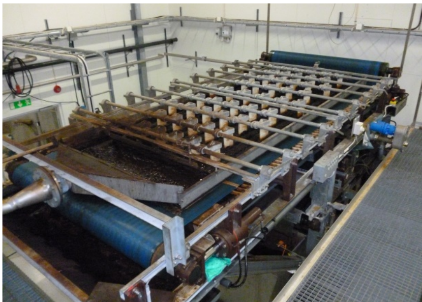
Figur 2. Silbandspressen som pressar upp slammets torrhalt till ca 15%.
