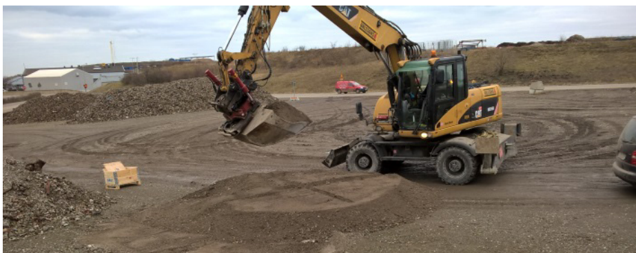
Figur 7. Provtagning av slaggrus vid SYSAV:s anläggning i Spillepeng, Malmö. (Foto Raul Grönholm).
