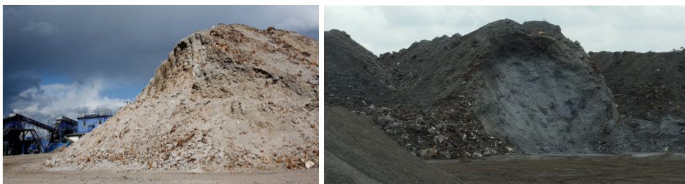
Figur 1. Förlager med slag från avfallsförbränning. I den högra bilden syns att upplagets kärna är ljusare än manteln. (Foto Raul Grönholm).
