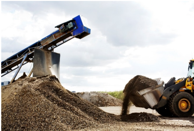
Figur 5. Slaggrus matas ut ur sorteringsanläggningen och körs till...
