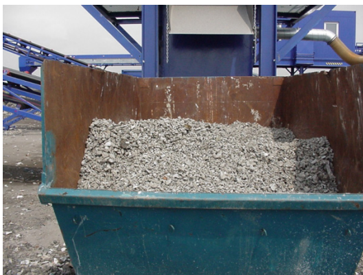
Figur 4. Container med utsorterade icke-magnetiska metaller (26-40) (främst koppar aluminium, mässing och zink) (Foto Raul Grönholm).
