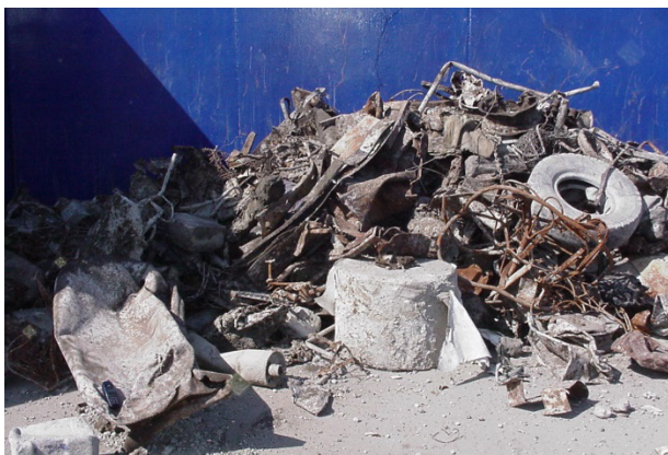
Figur 3. Överkorn (block och skrot) som inte ska komma in i slaggsorteringsanläggningen (Foto Raul Grönholm).
