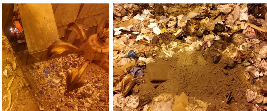
Figur 15 Inblandning av tvättad flygaska med avfallsbränsle. Till höger syns tvättad flygaska tippad på avfallet innan den blandats med avfallet.
