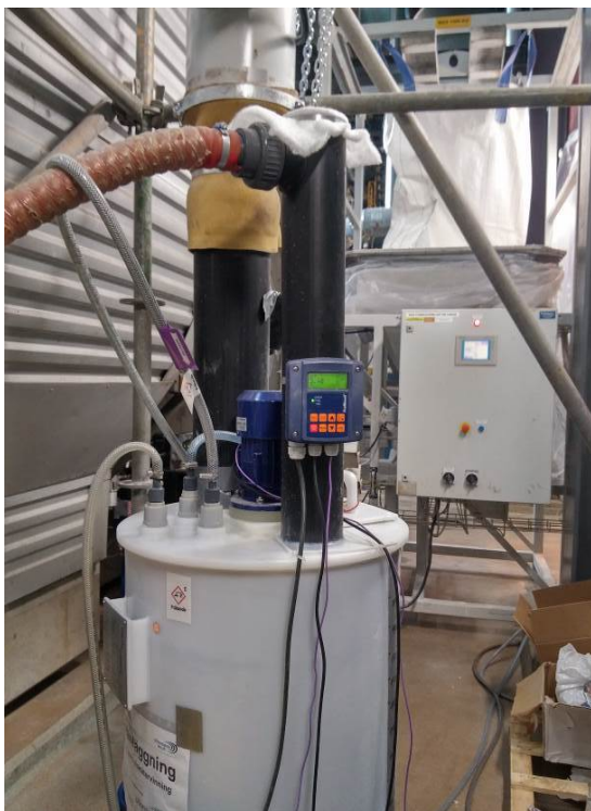
Figur 4 Slurryberedningstank med omrörare och pH-mätning. I bakgrunden syns den knivförsedda bigbagtömmaren, en vit bigbag med blåa lyftöglor och askdoseringsutrustningen.
