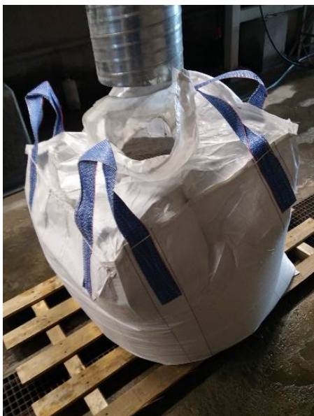
Figur 3 Bigbag, som precis fyllts med flygaska genom, det för ändamålet tillverkade, fyllnadsröret.
