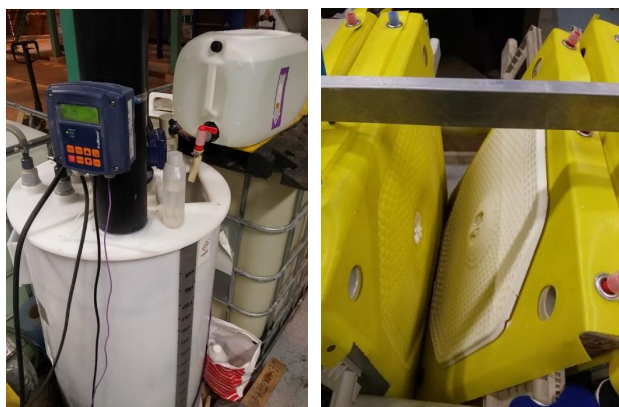
Figur 12 Fällningstank med pH-mätning och lutdosering (t.v.). Tvättad zinkhydroxidprodukt (t.h.).
