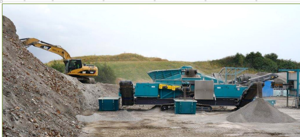
Figur 11. Sortering av slaggrus från KVV Filborna, Mobifloat BV, 2014
