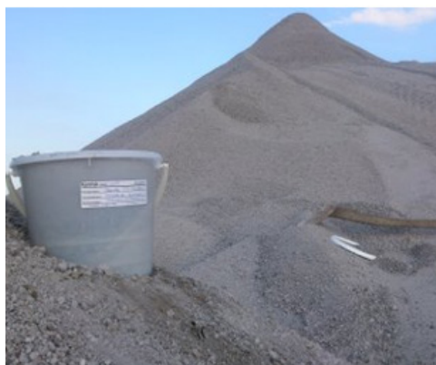
Figur 12 Slaggrus, 0-15 mm, respektive 15-55 mm
