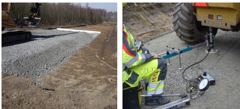
Figur 16 Statisk plattbelastning, mätning enligt TDOK 2014:041, enpunktsförfarande. Jämförande mätningar på försökssträckor med slaggrus respektive naturmaterial som förstärkningslager.
