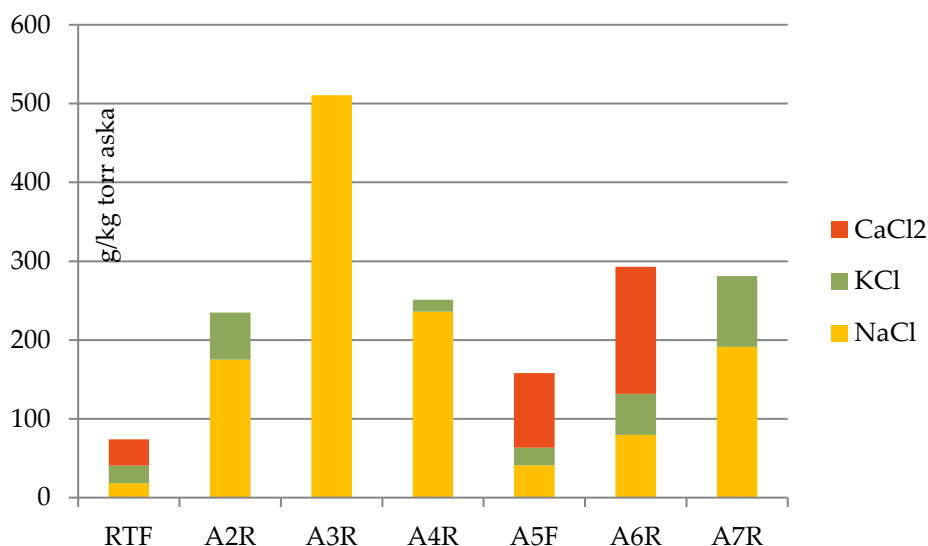
Figur 20 Beräknad sammansättning av salt när kloriderna begränsas; NaCl antas bildas före KCl.
