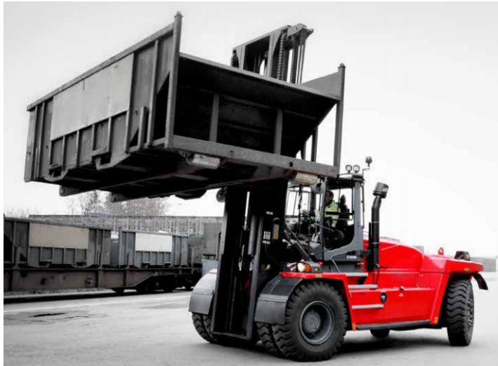
Kalmar forklift DCG180, lift capacity 18 tonnes (Kalmar)
