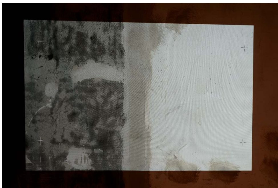
Figur B 1 Det valda undersökningsområdets hörnpunkter markerat med vita kors t.v. och med svarta kors t.h. (reseau-märken). Ytan är 2 x 1 m och är en del av f.d klimatrums i V-husets källare.
