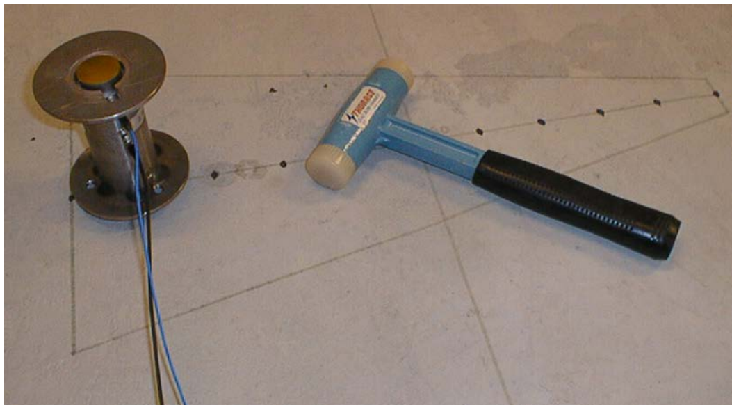
Figur 2 Närbild på det tidigare utvecklade impedanshandtaget t.v. som mäter både kraft i slaget och betongytans hastighet i slagriktningen. Dessa parametrar medger beräkning av betongytans impedans. Hammaren, en sk "Thorace dead blow hammer" är fylld med blykuler. Det gör den rekylfri, dvs inga studsar uppkommer. Det förlänger också impulstiden något.
