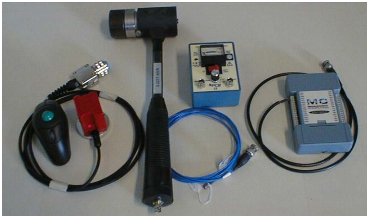
Figur 6 Trådlös, handhållen styrkula (Bluetooth), hastighetsgivare(röd), hammare med kraftgivare, ICP-förstärkare till kraftgivaren, trådlös MCC AD-omvandlare (Bluetooth).
