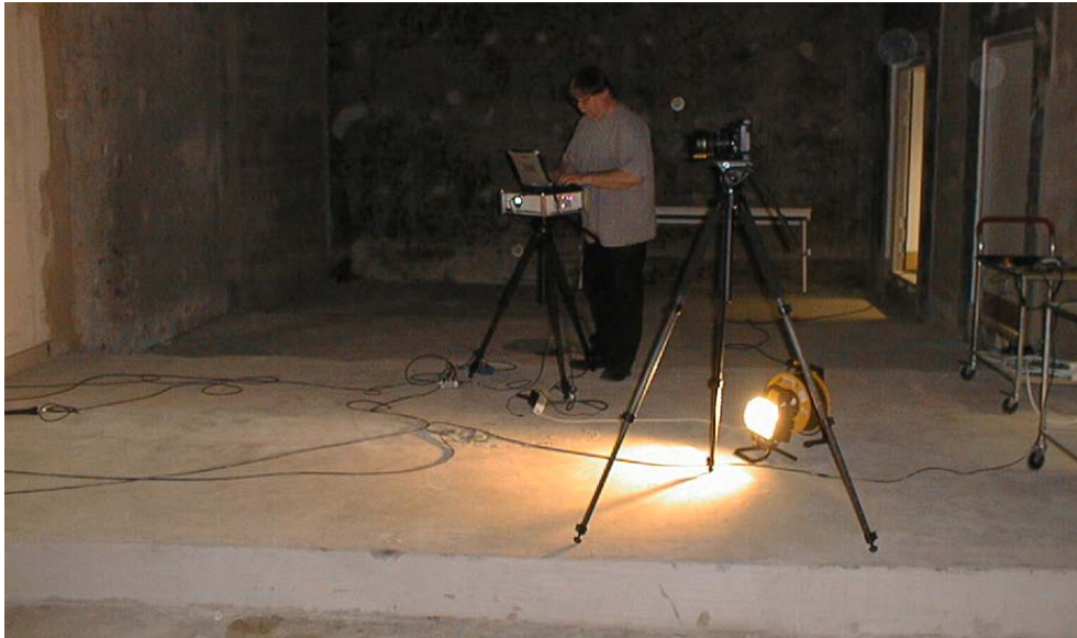
Figur B 5 De två stativen med kameran respektive projektorn. På projektorn står datorn som styr allt.
