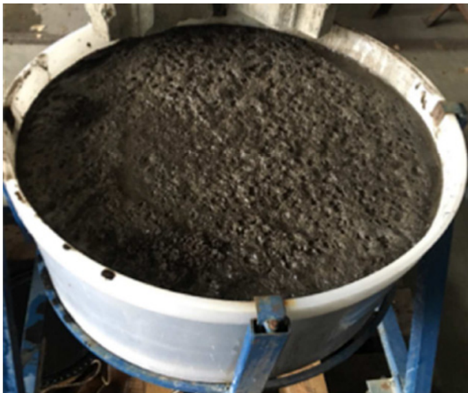
Figur 6-4 Biokol från bioslam, under avvattning Figure 6-4 Biocoal from biosludge, during dewatering
