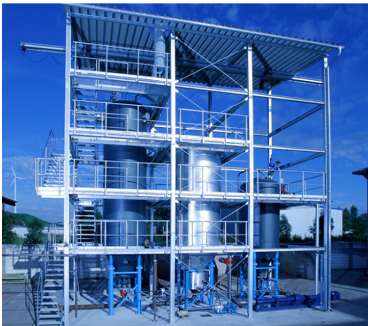
Figur 5-4 HTC-0, AVA-CO2 pilotanläggning med 14 m 3 reaktor
