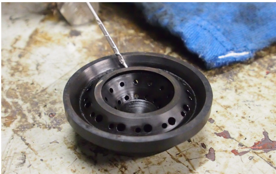
Bild 4. Originalmunstycke. Original nozzle.
