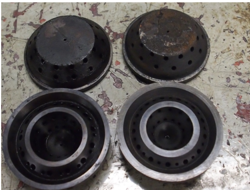
Bild 5. Originalmunstycke och egentillverkat munstycke. Original nozzle and the Karlsruhn designed nozzle.
