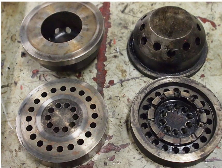
Bild 6. Orimulsionmunstycke. Orimulsion nozzle.
