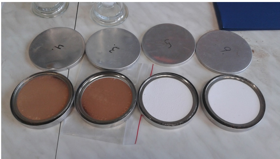
Bild 8. Stoftfilter, till vänster före elfilter och höger efter elfilter. Stoft filters, before and after ESP.
