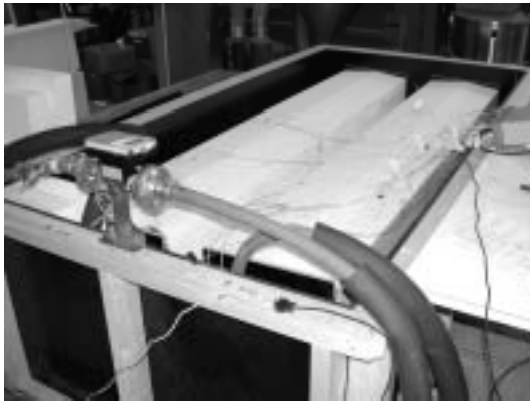
Figur 3.4 Trälåda med EPSPEX-kulvertar. Wooden box with EPSPEX pipes.
