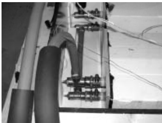
Figur 3.5 Anslutningar till pump- och värmesystem respektive mellan fram- och returledning. Connections to pump and heating system and between flow and return pipe respectively.
