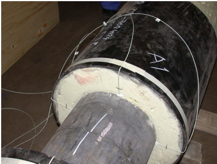
Figur 3.1 Placering av termoelement vid temperaturmätning Thermocouples for temperature measurements
