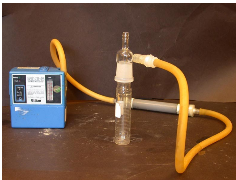
Figur 3.2 Utrustning vid provtagning med impinger Equipment for impinger flask sampling
