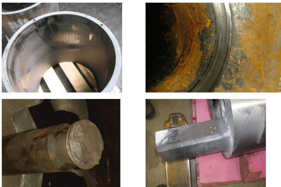
Figur 11 Skador på reglerventiler som uppkommit på grund av låg last med höga ånghastigheter genom ventilen [VGB Schröders bilder]
