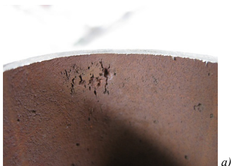
Figur 15. Lokala angrepp av frätgropar och SICC hos rörböj.
