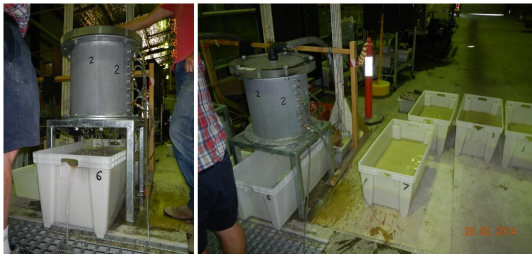
Figur 10 Igångsättning av test och uppsamling av genomläckt vatten och eroderade partiklar.
