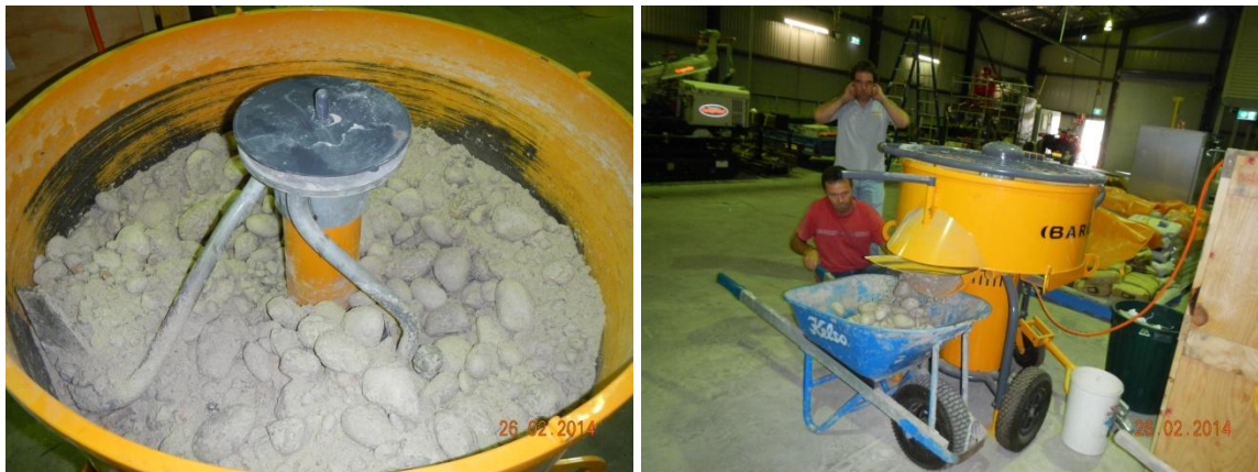
Figur 8 Pågående blandning av testmaterial i storskalig mixer.
