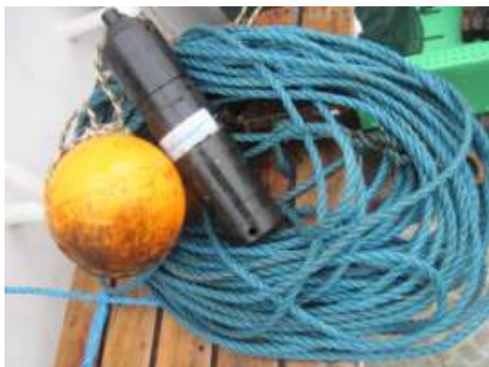
Figur 1. Hydrofonboj VR2 med flytkula som håller systemet upprätt och rostig ankarvikt skymtar under tampen (foto IL)).
