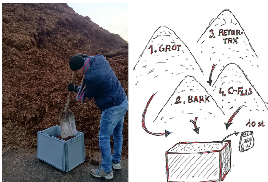
Figur 1. a) Paketering av trädbränsle på Johannes bränsleplan, Gävle Energi. b) Olika sorters bränsle har paketerats i provlådor för att därefter torkas i provpåsar och aluminiumformar.
