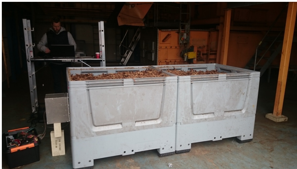
Figur 30. Två stycken provlådor om 800 liter och 120x100 cm som användes vid mätning på långa avstånd. Två lådor blir sålunda maximalt 240 cm.
