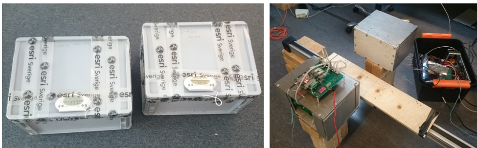
Figur 17. a) Provlådor med termometer. b) Steglös skanning av provlådor på linjärenhet.
