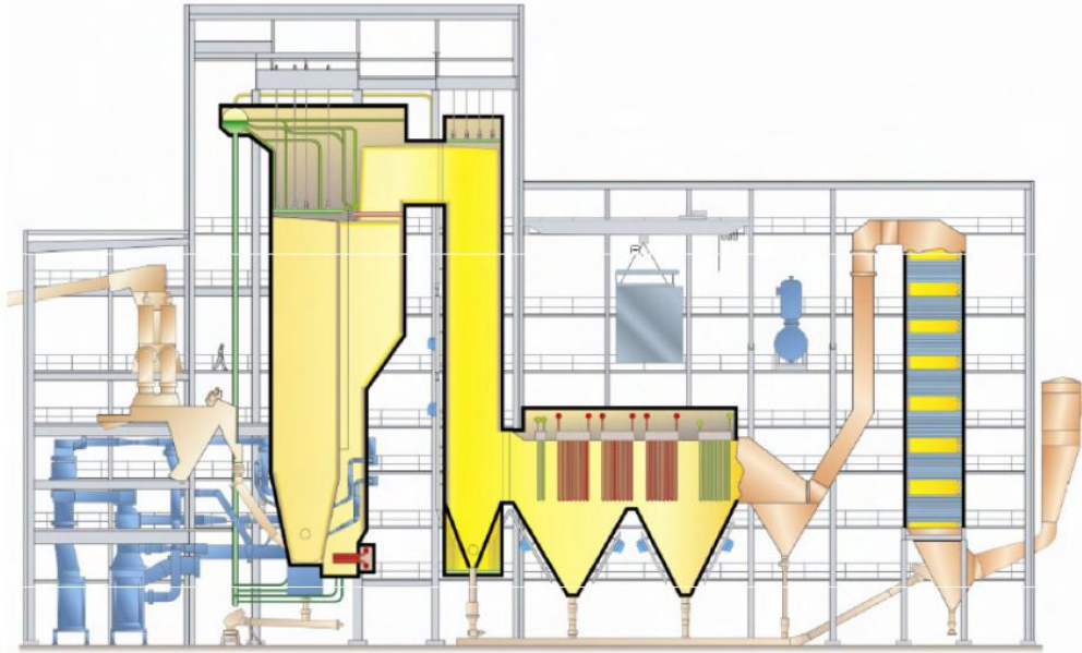
Figur 4-35. E.ON Värmes senaste CFB-panna i Händelö P15. Källa: Foster Wheeler [61].
