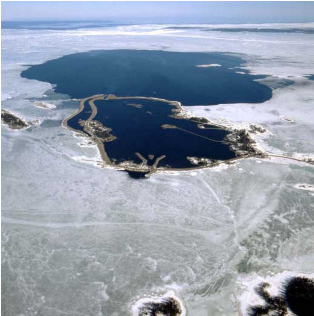
Bild 5.1. Kylvattenplymen utanför Forsmarks biotestanläggning flyter närmast utsläppet och förhindrar isbildning. Efter viss avkylning sjunker kylvattnet mot Öregrundsgreps botten. Foto genom Forsmarks Kraftgrupp AB.
