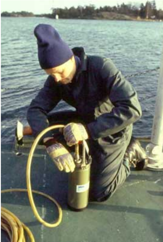
Bild 3.9. Automatiskt registrerande mätinstrument med ett antal temperaturgivare i en slang. Instrumentet hängs under ett bojsystem. Foto genom SMHI.
