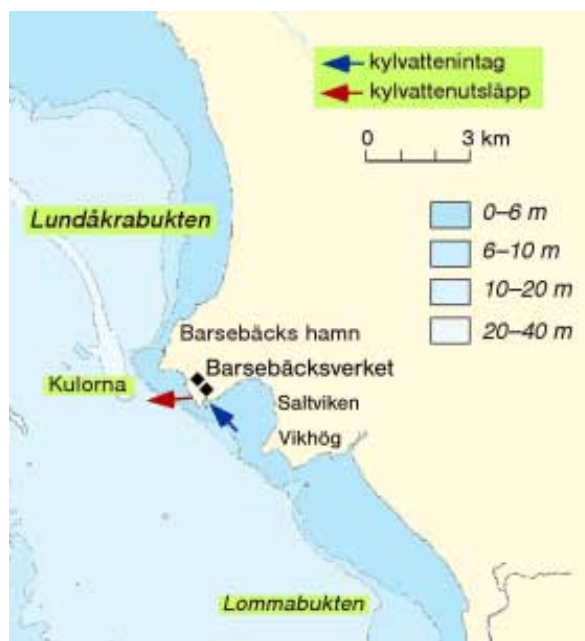
Figur 4.8. Öresund vid Barsebäcksverket med kylvattenintag och kylvattenutsläpp markerade. (Sjöfartsverkets K-Bas.)
