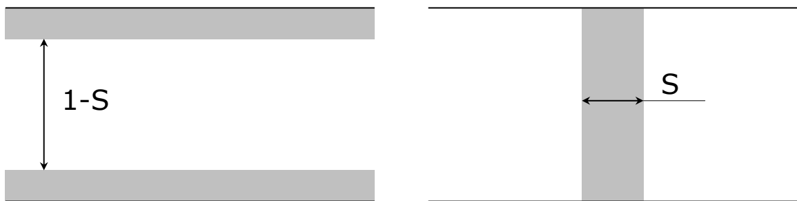
Figur 35 Två pormodeller för syrgasdiffusion visande helt öppen (vänster) och stängd (höger) por.
