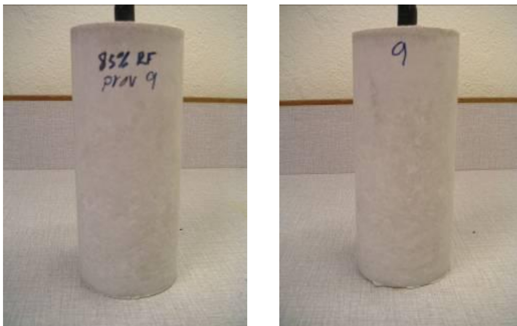
Figur 71 Betongprov 9 efter 238 dygn vid 85 % relativ fuktighet
