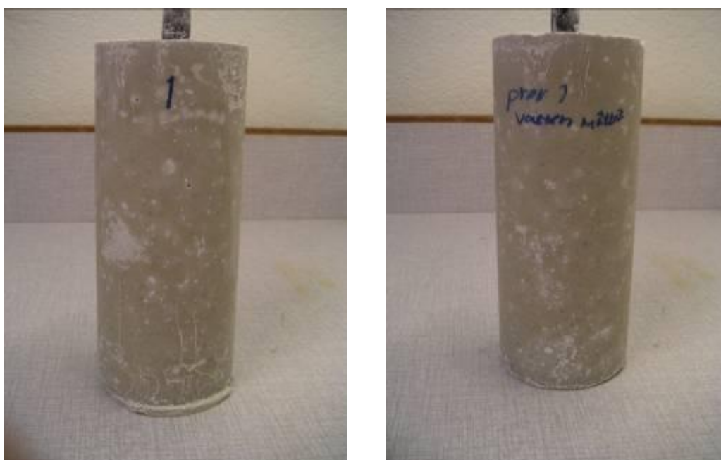
Figur 72 Betongprov 1 efter 238 dygn i 3 % NaCl.
