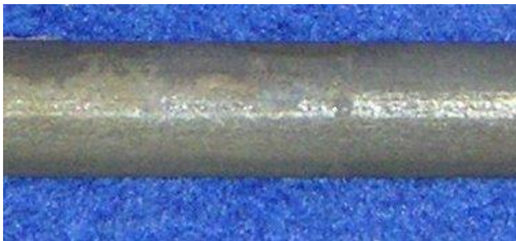
Figur 77 Angripna ytan hos prov 6 (-500 mV)
