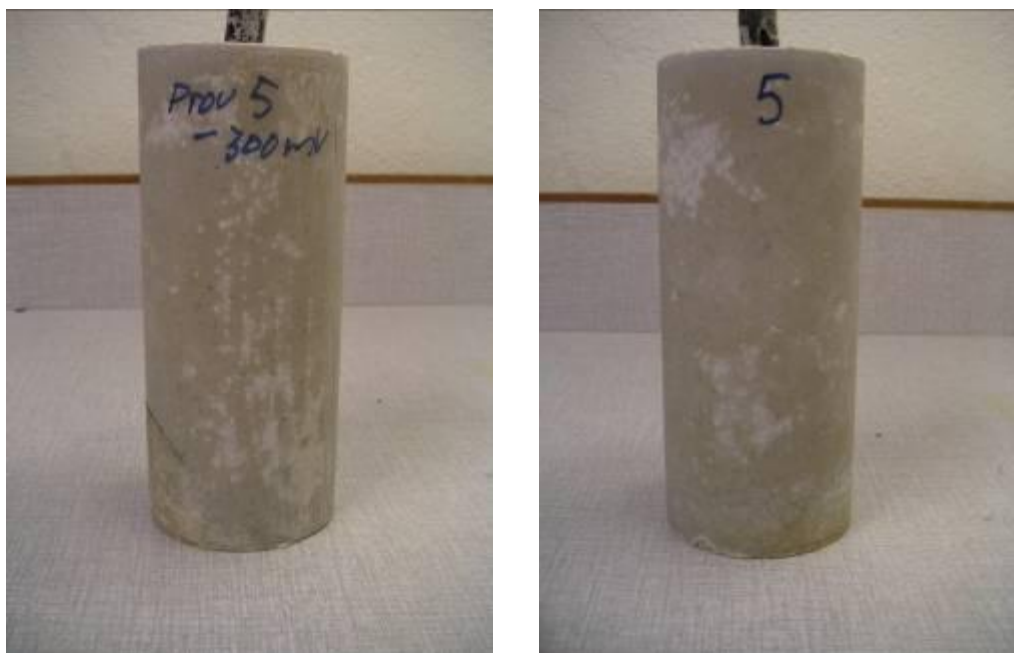
Figur 75 Betongprov 5 efter 81 dygns polarisering vid -500 mV.
