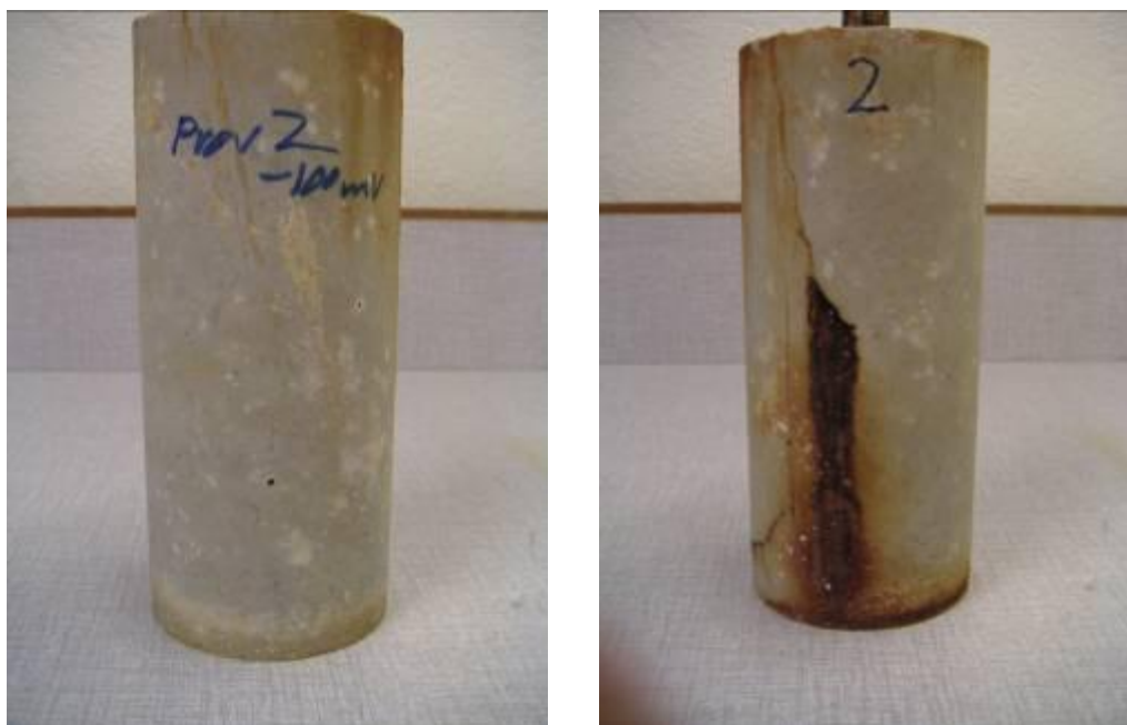
Figur 73 Betongprov 2 efter 81 dygns polarisering till -100 mV. Sprickan uppstod efter ca 40 dygn.
