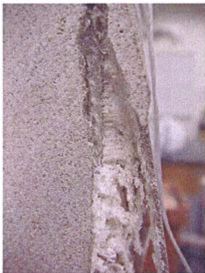
Figur 51: Avsprängning av ytskiktet på en sandstensprisma som sugit upp en 16-procentig lösning av Na 2 SO 4 och vars yta torkat i 30% rf. Figur från Scherer (2004).
