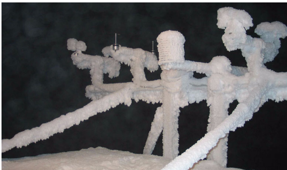
Figur 42. Enbart tillräckligt väl uppvärmda givare fungerar under svåra nedisningsförhållanden. Mätresultaten är dock, oavsett hur väl avisningen än fungerar, störda av den p.g.a. isen förändrade luftströmningen runt upphängningsanordningarna. Foto: Timo Laakso, VTT.
