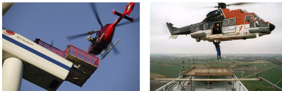
Figur 26. Helikopter kan användas vid transport till och från vindkraftverk. Nedisade firningsytor skulle dock försvåra eller till och med kunna omöjliggöra persontransport. Foto: Elsam.
