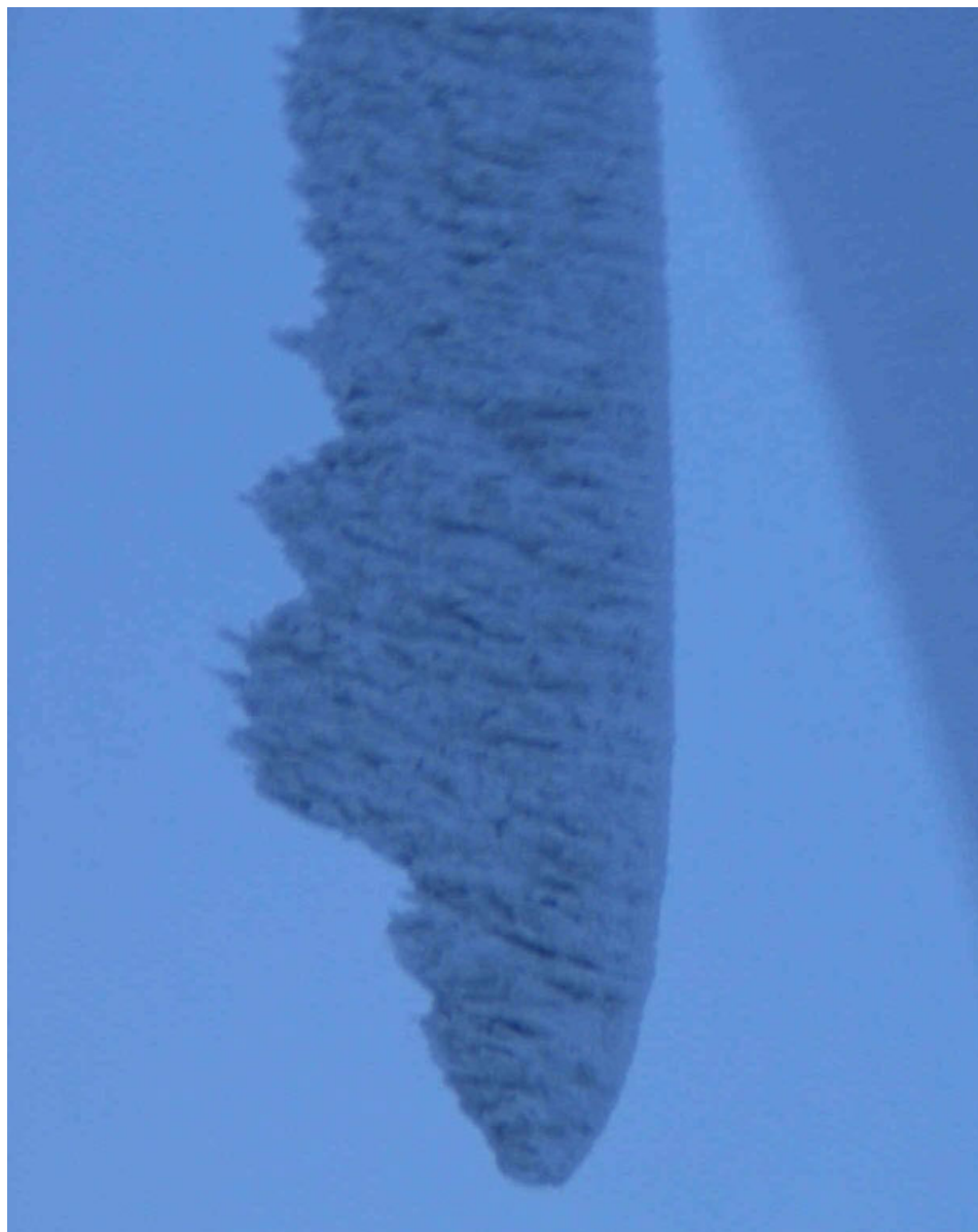
Figur 45. 600 kW Bonus aggregat på Olostunturi, Finland, 2004-01-20. Framkanten är t.v. i bilden. Bladvärmesystemet var ur funktion då en säkring hade löst ut. Foto: Timo Laakso, VTT.
