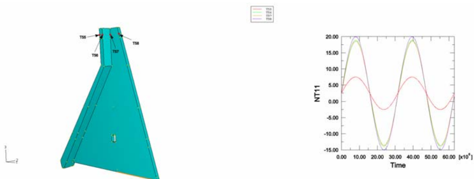
Figur 8.26 Temperatur för referensnoderna T55-T58 belägna mitt i monoliten
