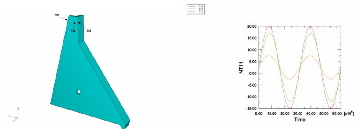
Figur 8.21 Temperatur för referensnoderna T51-T53 belägna mitt i monoliten
