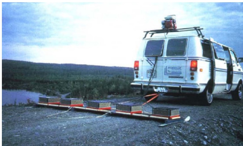
Figur 4-4. Mätning med georadar uppe på dammkrön. Bild från Sam Johansson et al (1995).
