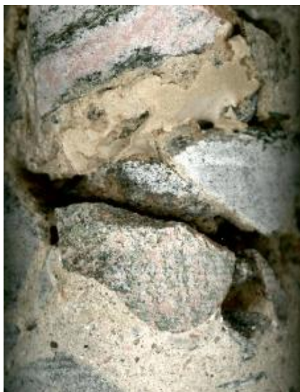
Figur 7. Borrkärna (55 mm) med urlakad betong och rester av gammalt cementbruk ovanför den urlakade zonen (t.v.). Sprickbildning i betong (t.h.).
