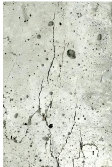
Figur 7. Borrkärna (55 mm) med urlakad betong och rester av gammalt cementbruk ovanför den urlakade zonen (t.v.). Sprickbildning i betong (t.h.).
