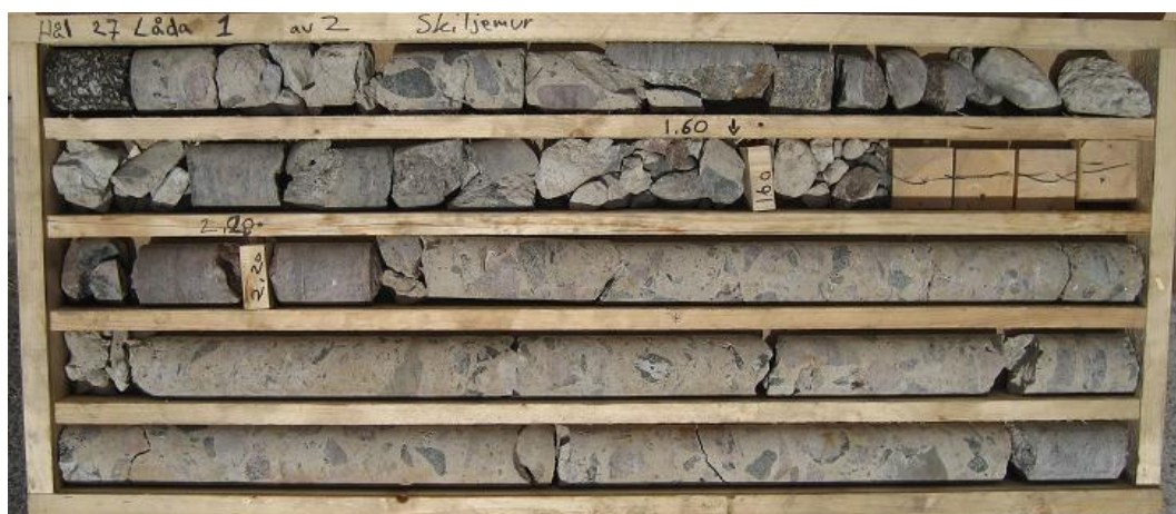
Figur 8. Förvaringslåda för borrhärnor inför kärnkartering.
