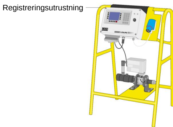
Figur 22. Illustration av registreringsutrustning för tryck, flöde, m.m. [4].
