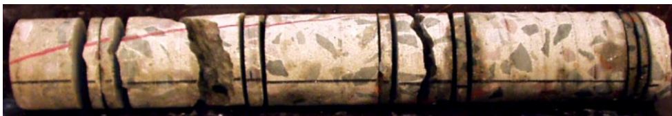
Figur 2-4 Exempel på borrhärla, från pos 6 C4, med sprickor och utsågade skivor
