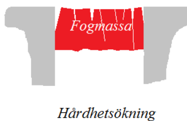
Figur 4-7 Åldring där fogmassan blivit hårdare/försprödat och till sist krackelerat.
