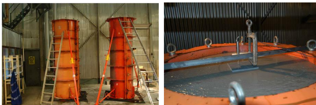
Figur 5-10 Provgjutning av 3 m hög betongcylinder, från Vogt et al. (2009).
